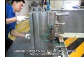
図9 小型金型の例手動作動チェック
